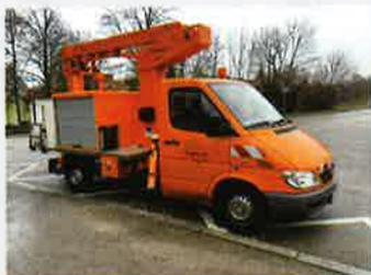
Der Ruthmann-Steiger mit einer maximal auszufahrenden Arbeitsbühne von 10,25 m und einer Zulassung der Hebebühne für zwei Personen, eignet sich für verschiedene Arbeiten, wie auch für die Reparaturen und die LED-Umstellung der Straßenbeleuchtung.
